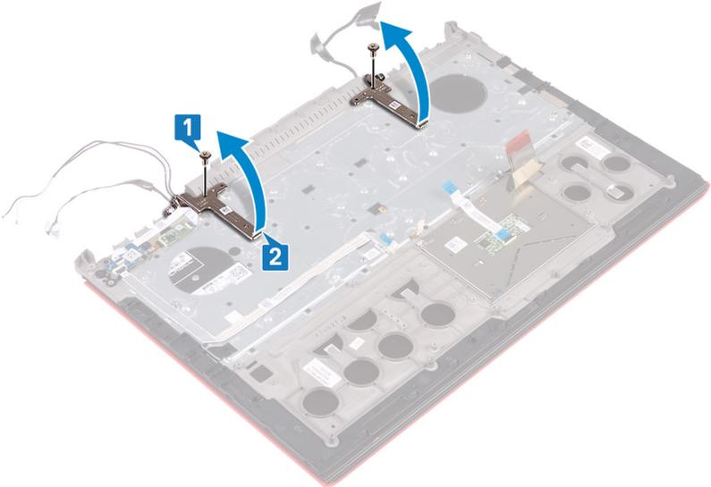
**3** Levante el ensamblaje del reposamanos del ensamblaje de la pantalla.
